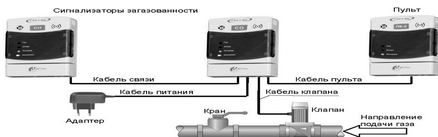
Рис. 1. Схема работы датчика-газоанализатора
