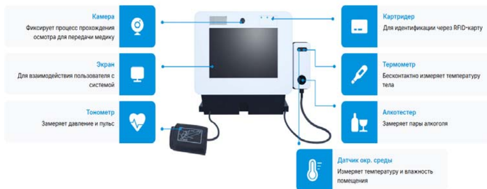
Рис. 1. Состав аппаратных компонентов стационарного комплекса дистанционного медицинского осмотра
