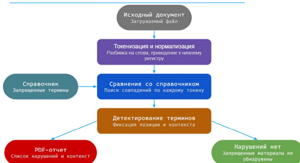
Рис. 2. Схема работы поискового движка
