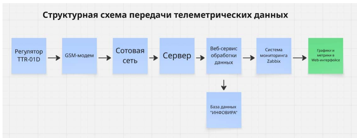
Рис. 1. Структурная схема архитектуры системы автоматизированного мониторинга
