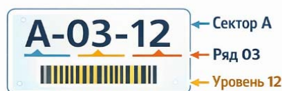
Рис. 3. Схема адресного хранения на складе в WMS
