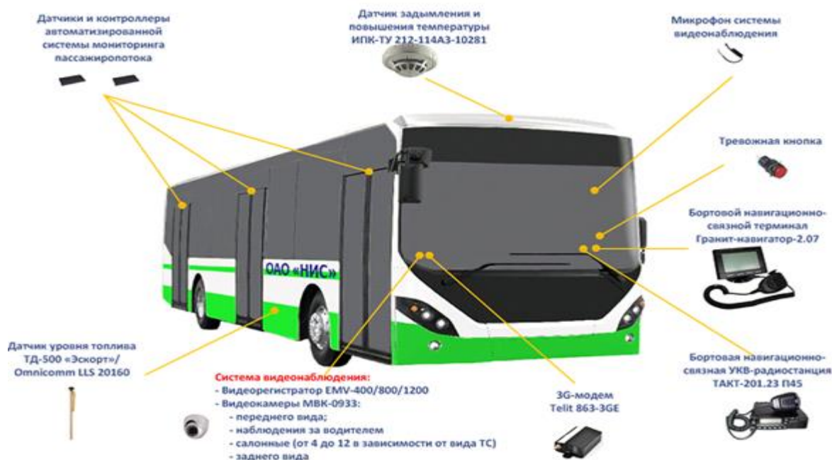
Рис. 4. Комплект оснащения пассажирского транспортного средства ГУП «Мосгортранс»
