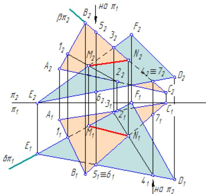
Рисунок 5.2.3 – Построение линии пересечения двух плоскостей
