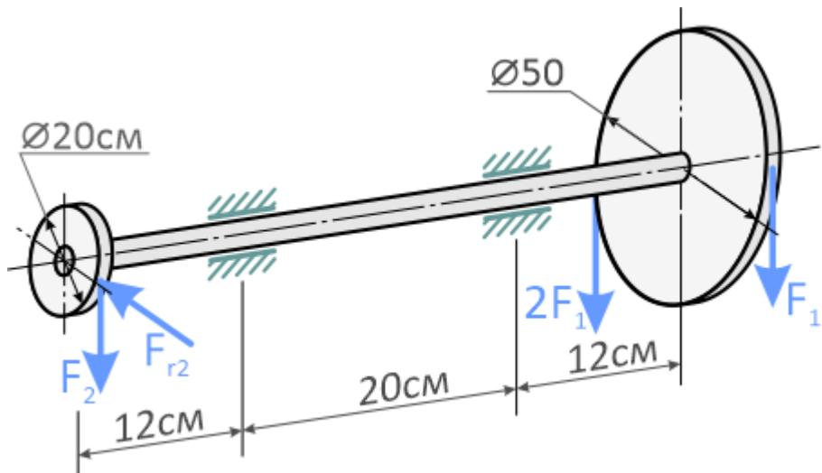
Определить силы  $F_2$ ,  $Fr_2 = 0,4 \cdot F_2$ , а также реакции в подшипниках, если значение силы  $F_1 = 834$  Н.
