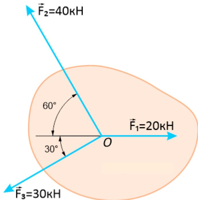
Требуется найти равнодействующую сил, действующих на тело, т.е. определить её величину и положение аналитически и графически.
