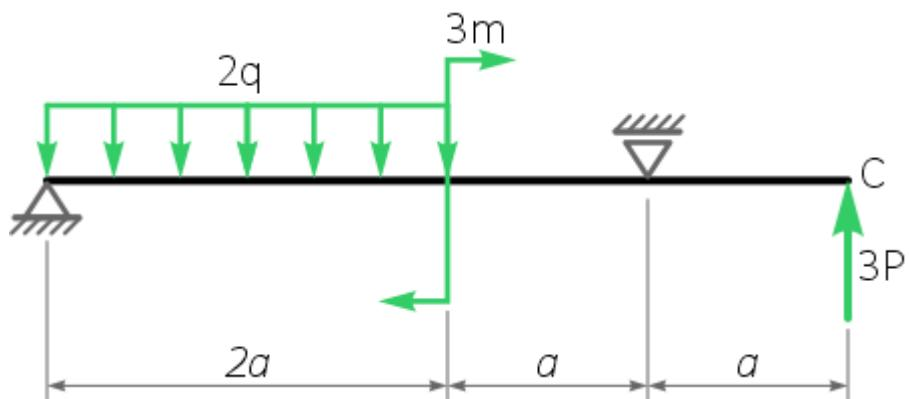
Дано:  $q = 2 \text{ кН/м}$ ,  $P = 4 \text{ кН}$ ,  $m = 2 \text{ кН}\cdot\text{м}$ ,  $a = 2 \text{ м}$ .
