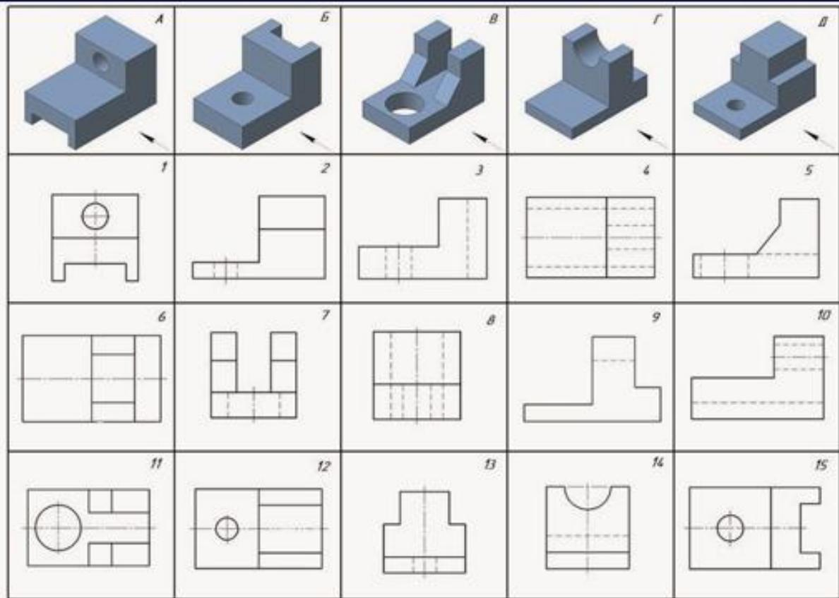
Задание 2: По аксонометрическому чертежу выполнить чертеж детали в необходимом количестве видов, постройте целесообразный разрез, нанесите размеры.
