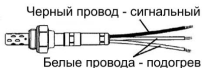
Рис. 7.3. Трехпроводной кислородный датчик.
