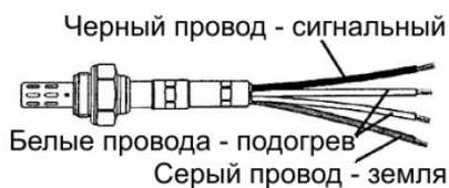
Рис. 7.4. Четырехпроводной кислородный датчик.
