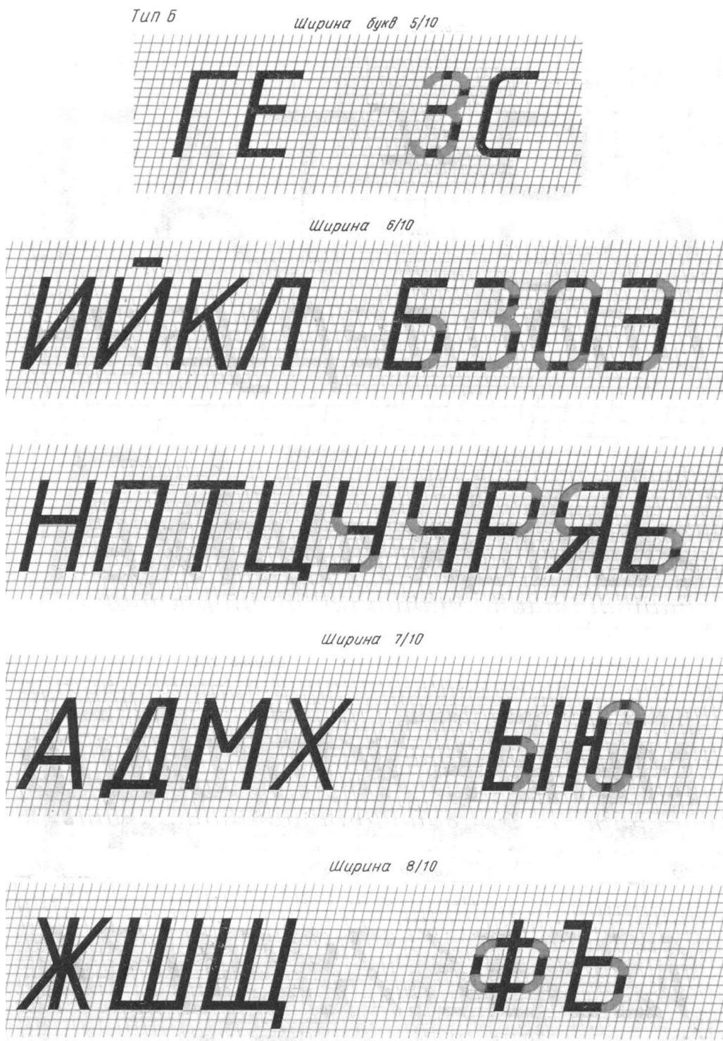
Рис. 1.9. Построение прописных букв шрифта типа *Б* с наклоном, расположенных группами по ширине букв
