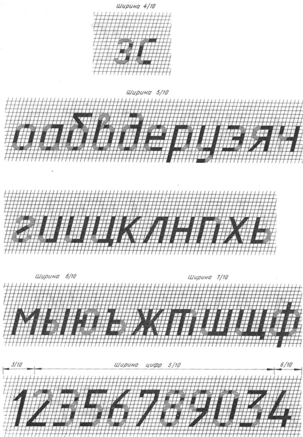
Рис. 1.10. Построение сточных букв шрифта типа *B* с наклоном, расположенных группами по ширине букв
