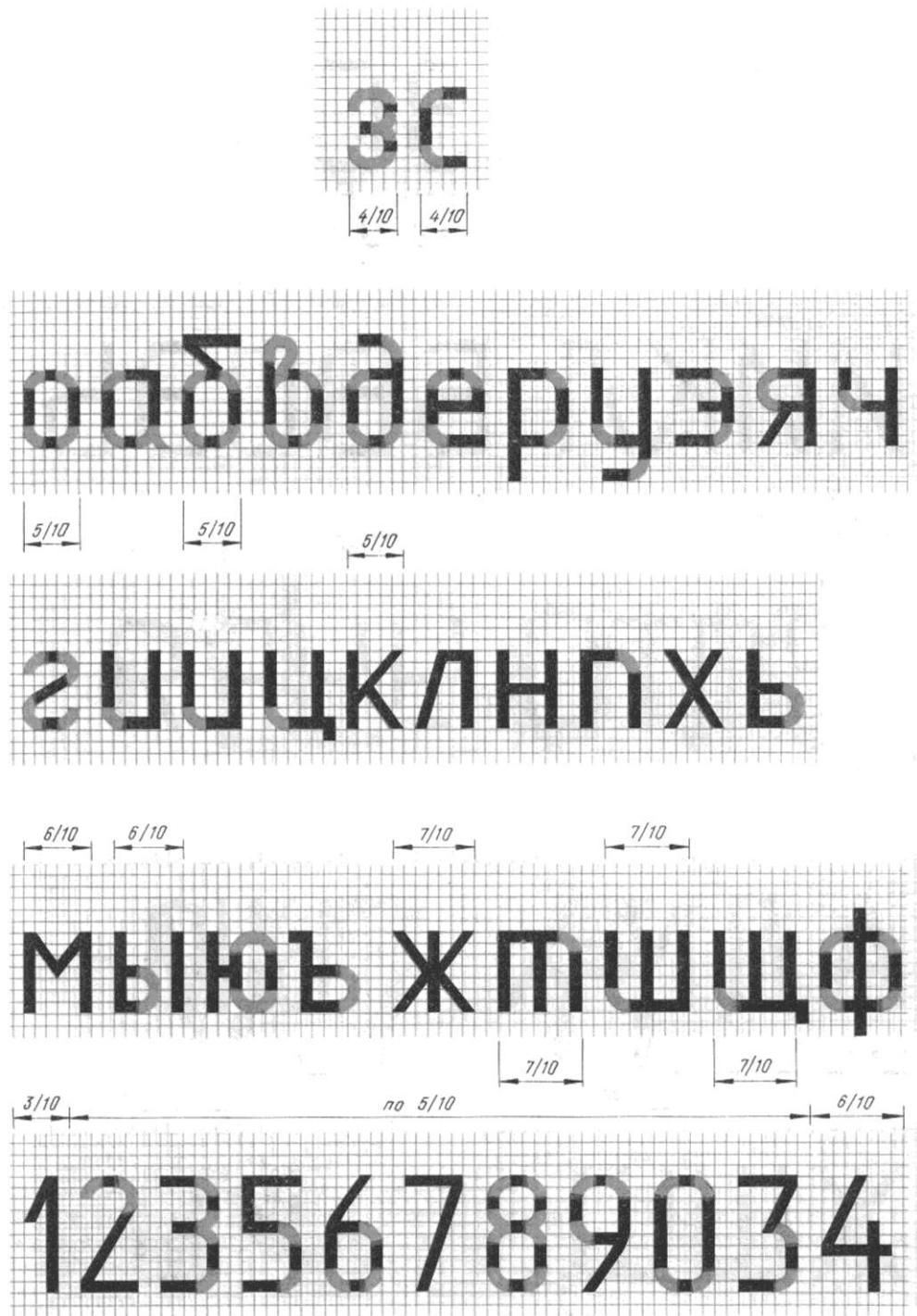
Рис. 1.8. Построение строчных букв шрифта типа *Б* без наклона, расположенных группами по ширине букв
