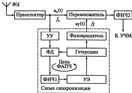
Рис. 1.8. Структурная схема РПрУ прямого преобразования
