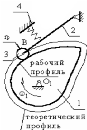
Рис. 8.1. Высшая кинематическая пара: 1 – кулачок; 2 – толкатель; 3 – ролик; 4 – пружина
