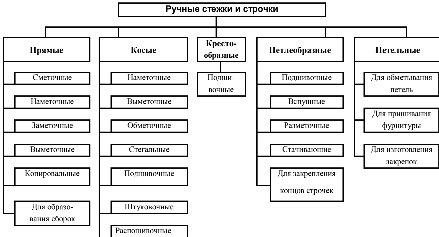
Рисунок 4 - Классификация ручных стежков и строчек
