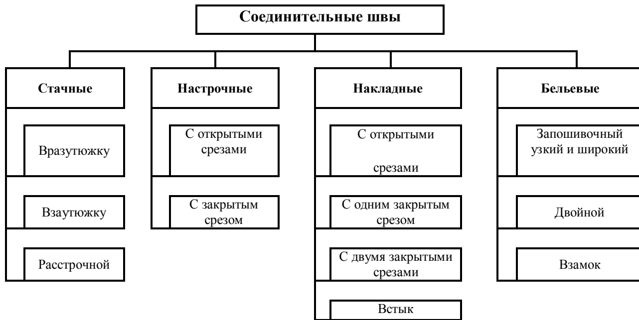
Рисунок 10 – Классификация соединительных швов
