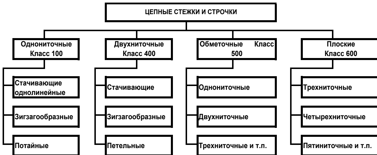
Рисунок 9 – Классификация цепных стежков и строчек
