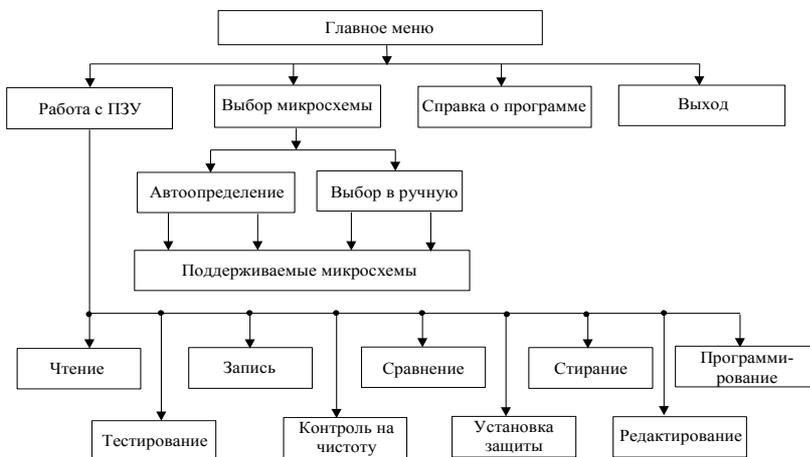
Рис. 6.2. Структурная схема интерфейса программного обеспечения
