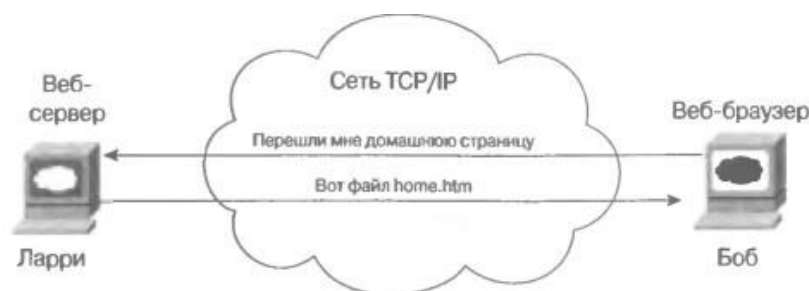
Рисунок 3 – Схема работы приложения с веб-сервером
