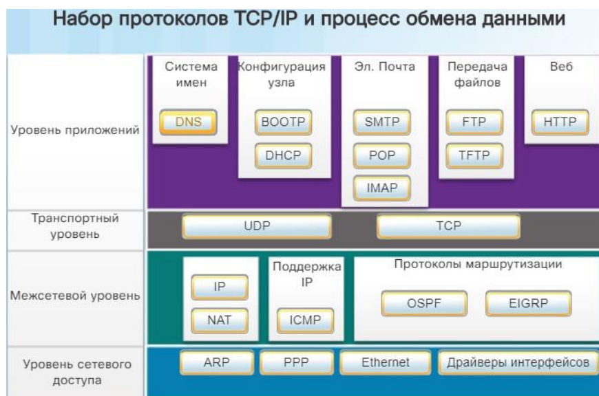
Рисунок 2 – Набор протоколов стека TCP/IP
