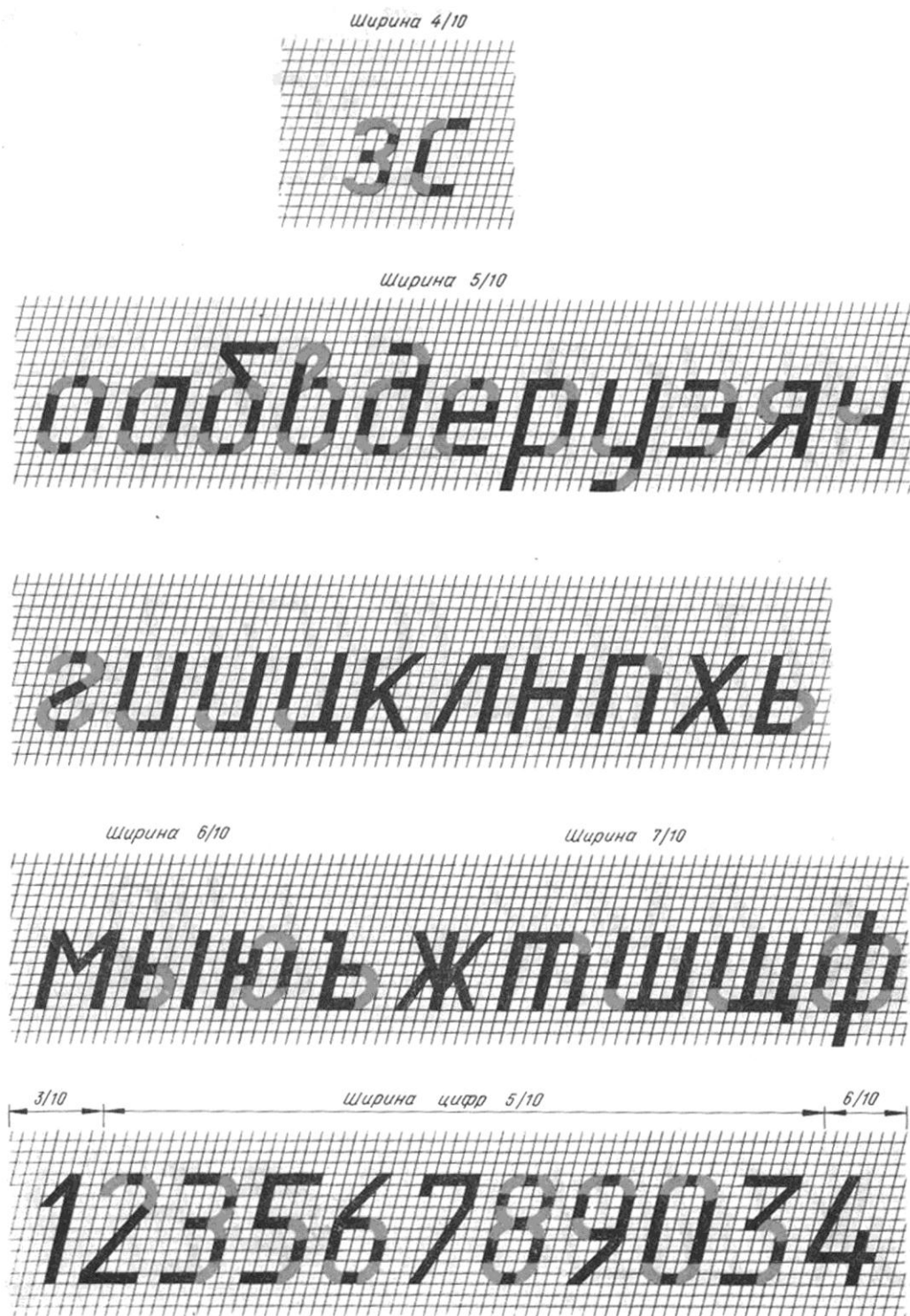
Рис. 1.10. Построение сточных букв шрифта типа Б с наклоном, расположенных группами по ширине букв
