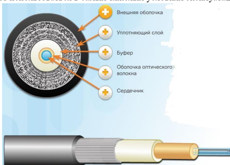
Рисунок 10 Конструкция оптоволоконного кабеля
