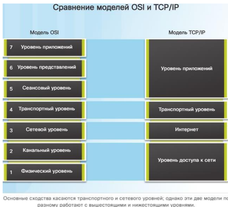
Рисунок 9 - Сравнение моделей OSI и TCP/IP
