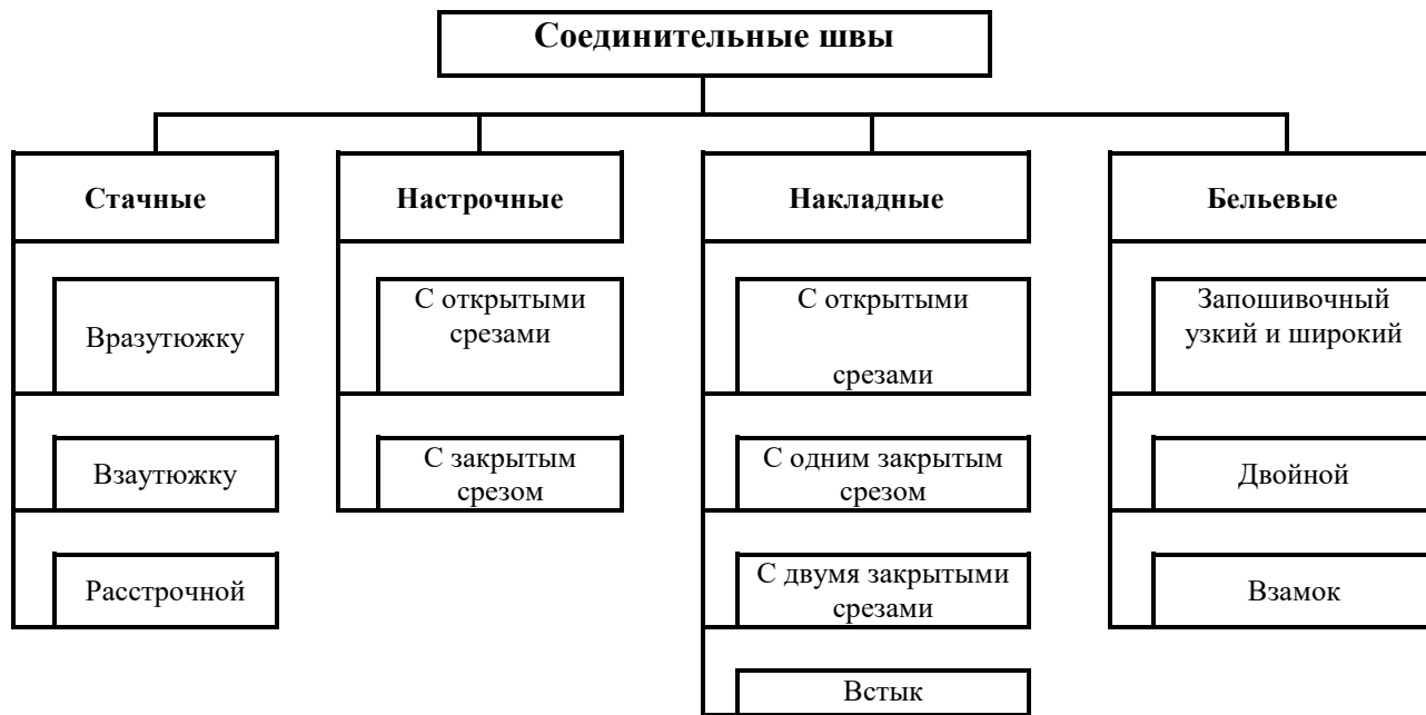
Рисунок 10 – Классификация соединительных швов
