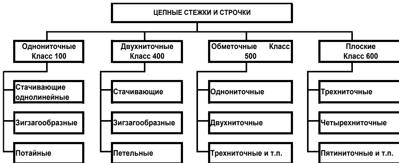
Рисунок 9 – Классификация цепных стежков и строчек
