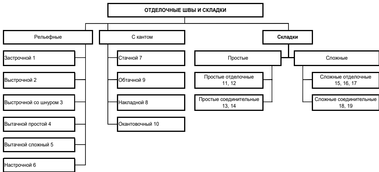
Рисунок 13 – Схема видов отделочных швов и складок
