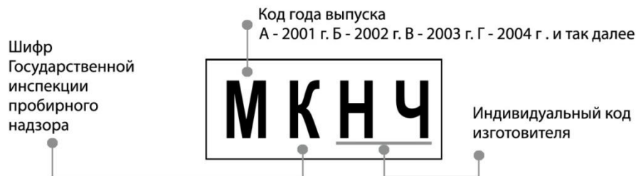
Рисунок 1 – Схема оттиска клейма изготовителя
