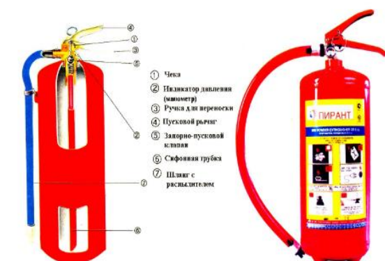
Схема огнетушителя порошкового ОП-5(з) (закачного типа)
