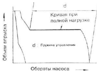
Рис. 10.9. График зависимости объема впрыска от оборотов насоса с указанием действующих пружин
