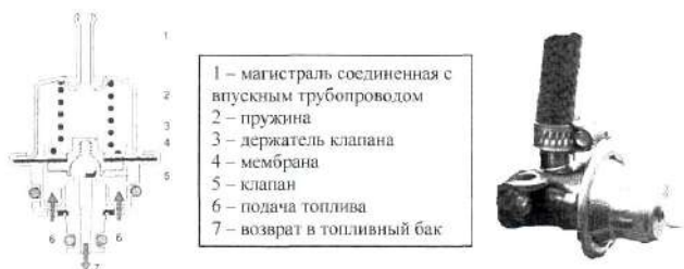
Рис. 6.10. Регулятор давления
