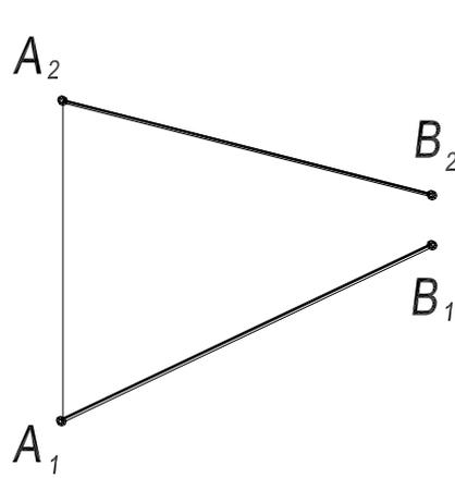
17. Определить натуральную величину отрезка **AB** и углы наклона к плоскостям проекций.
