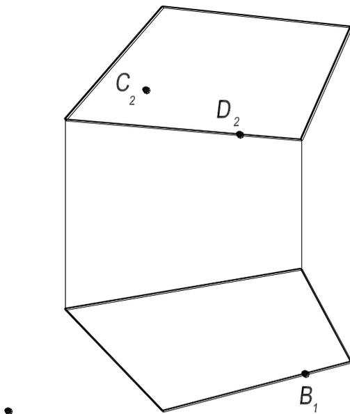
31. Достроить горизонтальную проекцию плоской фигуры.
