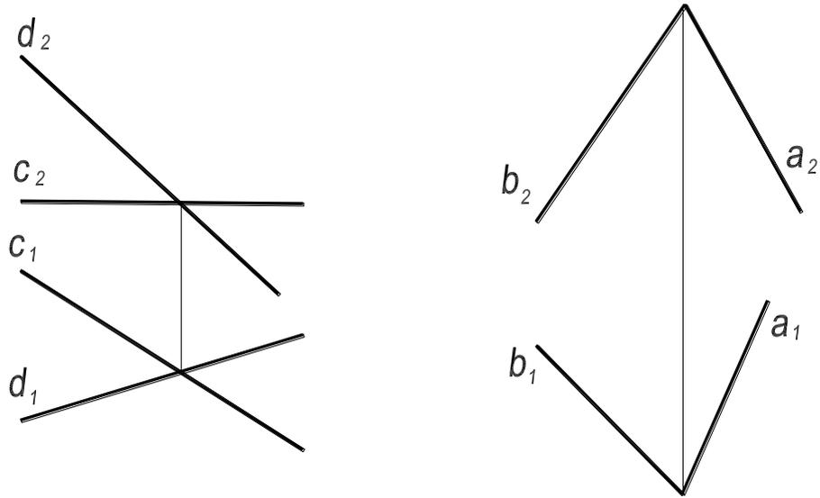
38. Построить проекции точки пересечения прямой  $m$  с проецирующей плоскостью. Определить видимость прямой  $m$ .
