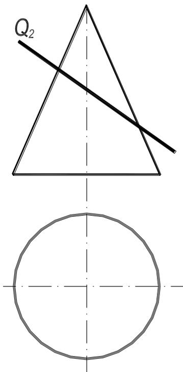
50. Построить три проекции поверхности усеченного конуса с отверстием.
