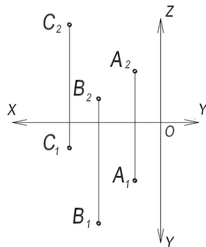
4. Обозначить элементы чертежа. Построить три проекции каждой из точек **A, B, C** на комплексном чертеже. Координаты точек (в мм): **A(40,25,10)**, **B(20,10,0)**, **C(10,0,30)**. Построить изометрические проекции данных точек, используя приведенные коэффициенты искажения.
