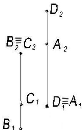
16. Построить проекции точки **C**, делящей отрезок **AB** в отношении 4:1.
