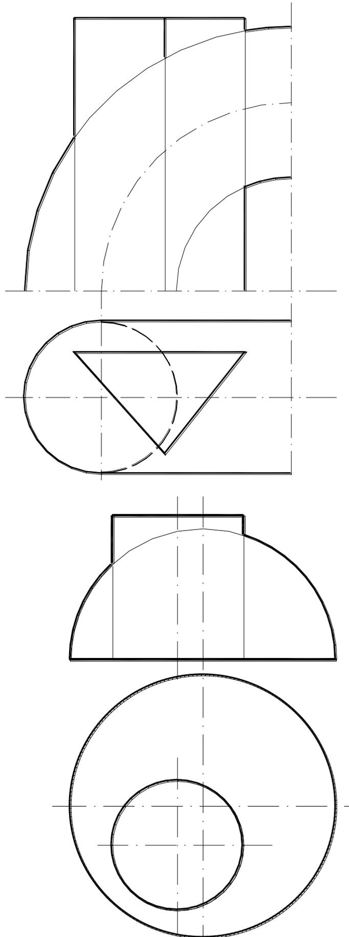
54. Построить проекции линии пересечения поверхностей. Построить аксонометрические проекции.
