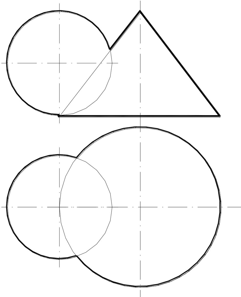
53. Построить проекции линии пересечения поверхностей.
