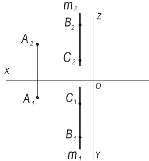
22. Через точку **A** провести прямую, параллельную плоскости проекций  $\Pi_2$  и пересекающую прямую **m**.
