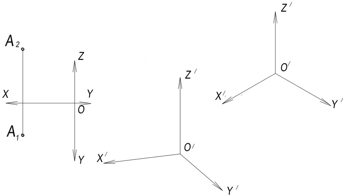
8. Обозначить элементы чертежа. Построить наглядное изображение цилиндра в прямоугольной изометрии.
