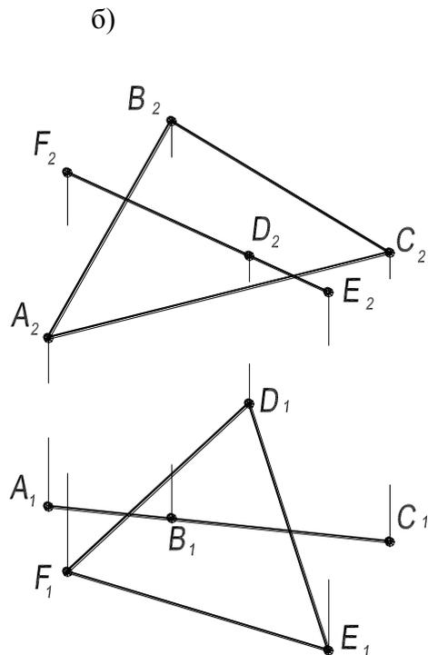
36. Построить линию пересечения проецирующей плоскости с плоскостью заданной:
