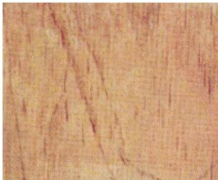
Рис. 1.11. Радиальный разрез ствола клена
