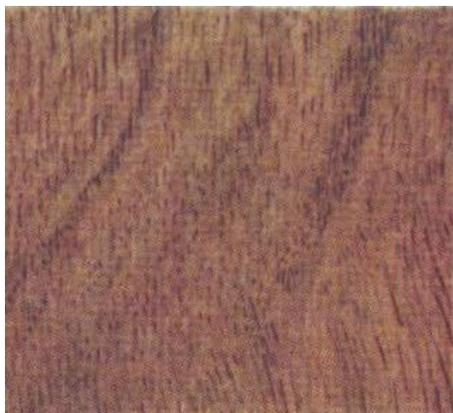
Рис. 1.8. Тангентальный разрез ствола ореха
