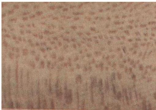
Рис. 1.12. Тангентальный разрез ствола платана
