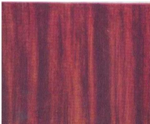
Рис. 1.4. Тангентальный разрез тиса
