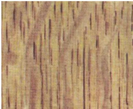
Рис. 1.6. Радиальный разрез дуба
