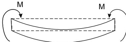
Рис. 2.11. Пример деформации изгиба
