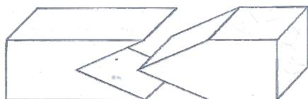
Рис. 1.44. На зубчатое клеевое соединение
