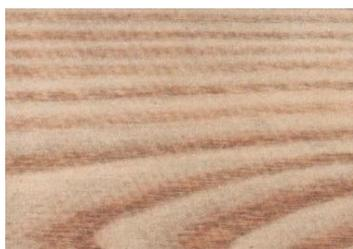
Рис. 1.5. Тангентальный разрез ясеня
