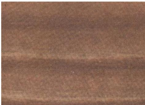
Рис. 1.14. Радиальный разрез ствола лоха
