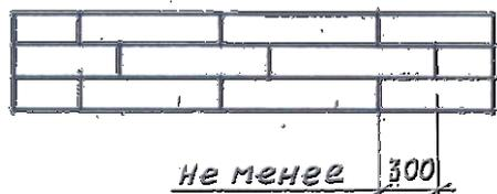
Рис. 1.39. Смещение мест соединения
