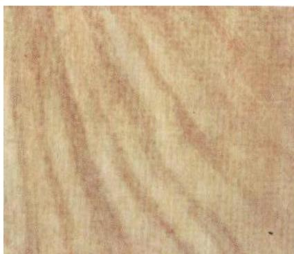
Рис. 1.9. Тангентальный разрез ствола березы
